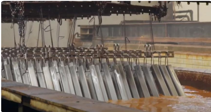
Figura 3 Acero en baño de sales. Fuente: Ruiz, E. (2016) Guía práctica para galvanizado por inmersión en caliente . Recuperado de https://www.idu.gov.co/web/content/7423/guia_galvanizado_24nov14+(1).pdf
