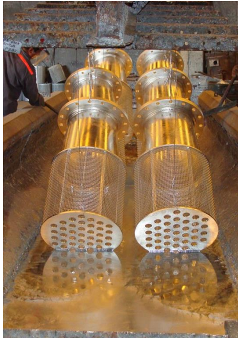
Figura 4 Piezas galvanizadas sobre el zinc fundido. Fuente: Calidad de Metalyzinc.
